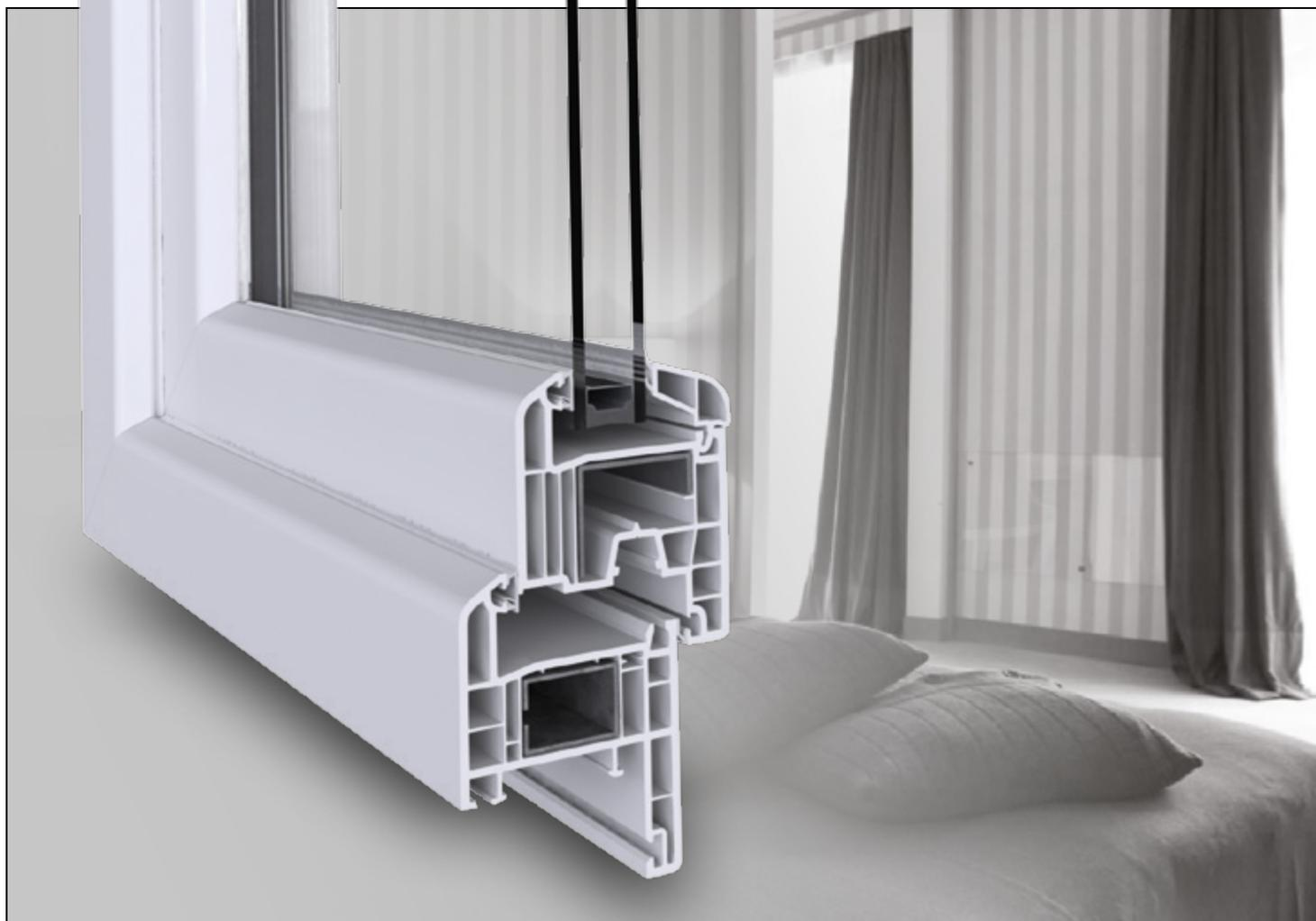
Sistema costruito con profilo in PVC di Alphacan spa, estruso in Italia, ad ARCO - TN, rigidoantiurtizzato e stabilizzato con calcio-zinco (esente da piombo), Classe A, capace sia di stabilità alla luce secondo la normativa UNI EN 513 sia di resistenza alle forti escursioni termiche secondo la normativa UNI EN 12608 per la zona climatica Italia appartenente alla categoria clima SEVERO identificata dal marchio "S".
