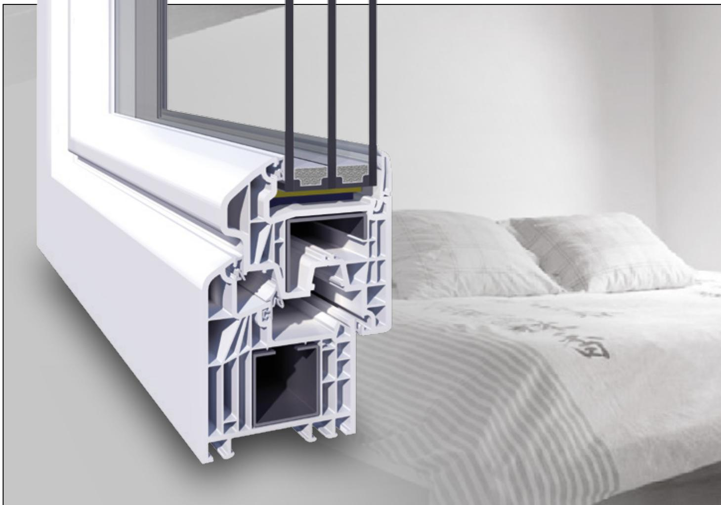
Sistema costruito con profilo in PVC di Alphacan spa, estruso in Italia ad ARCO - TN, rigidoantiurtizzato e stabilizzato con calcio-zinco (esente da piombo), Classe A, capace sia di stabilità alla luce secondo la norma UNI EN 513 sia di resistenza alle forti escursioni termiche secondo la norma UNI EN 12608 per la zona climatica Italia appartenente alla categoria clima SEVERO identificata dal marchio "S".
